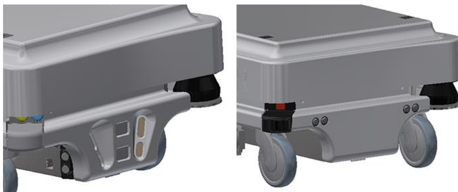
Figura 7.10. Sul robot sono presenti due sensori a ultrasuoni: due nella parte anteriore (sinistra) e due nella parte posteriore (destra).
