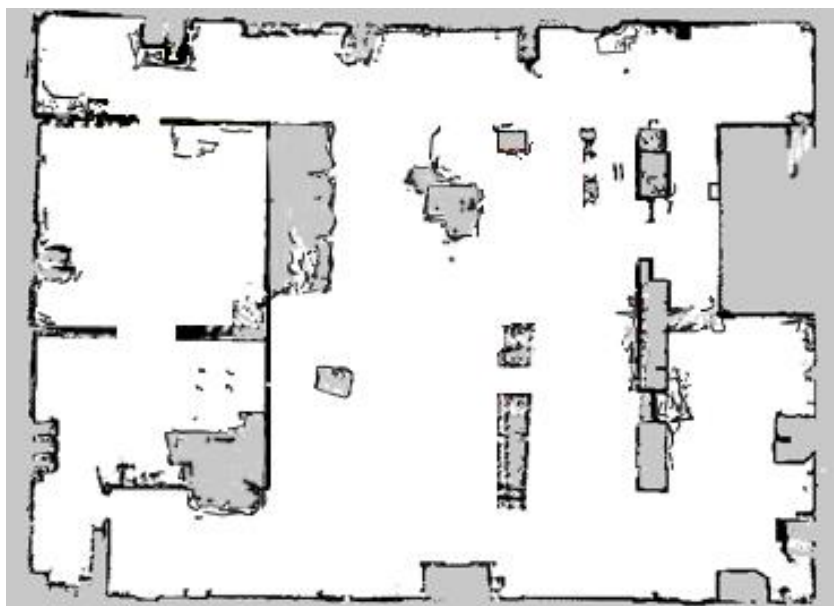
Figura 9.3. Esempio di mappa con imperfezioni e ostacoli dinamici.
