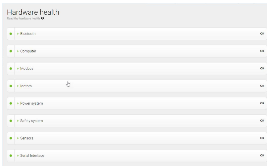
Figura 17.1. Nella sezione Hardware health (Condizioni dell'hardware) dell'interfaccia viene visualizzato il componente che non funziona, spesso con l'indicazione del motivo.
